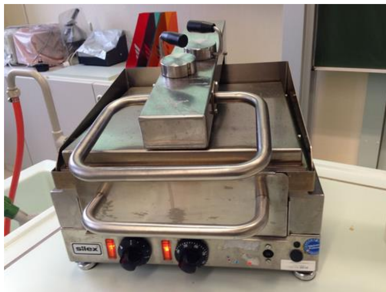
Der High- Tech- Grill zur Bestimmung des Grillsaftverlustes, welcher feinsten Fleischduft Zimmer verbreitete und dem einen oder anderen mächtig Appetit machte
