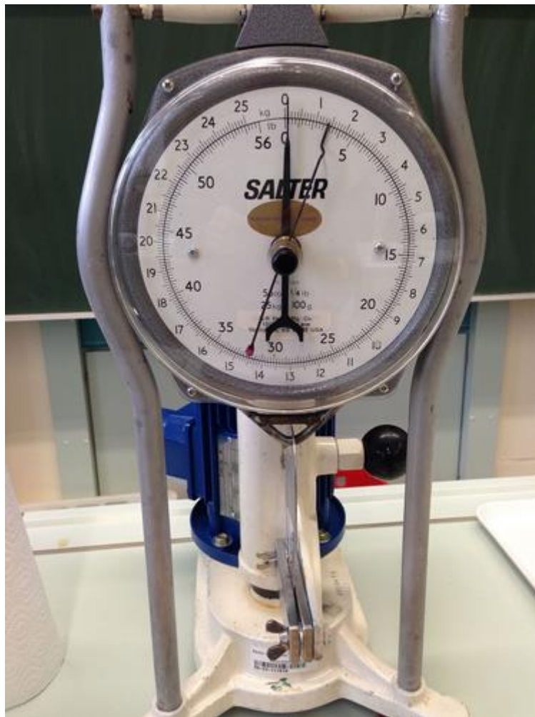
Bestimmung der Scherkraft (Zartheit des Fleisches mit dem „Warner- Bratzler- Scherkraftmesser)
